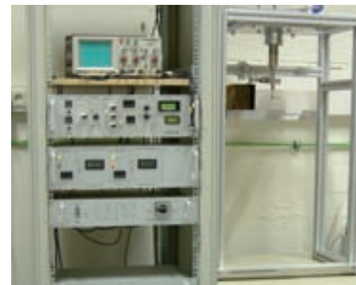
BILD 3: EINER VON INSGESAMT ZWEI AM LEHRSTUHL VERFÜGBAREN ULTRASCHALLERMÜDUNGS-PRÜFSTÄNDEN ZUR DURCHFÜHRUNG VON HOCHFREQUENTEN (CA. 20 KHZ) SCHWINGUNGSTESTS.
