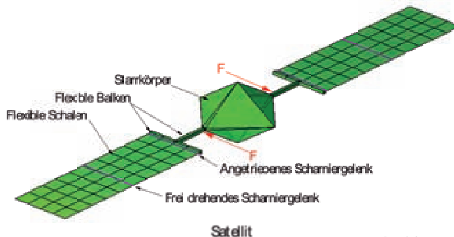
BILD 1: SCHEMATISCHER AUFBAU DES SATELLITENBEISPIELS
