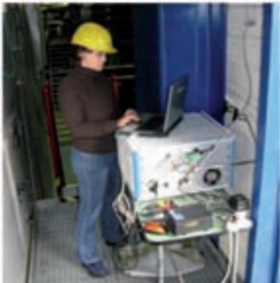
BILD 2: ERDGASANALYSE IM KRAFTWERK MITTELS RAMANSTREUUNG
