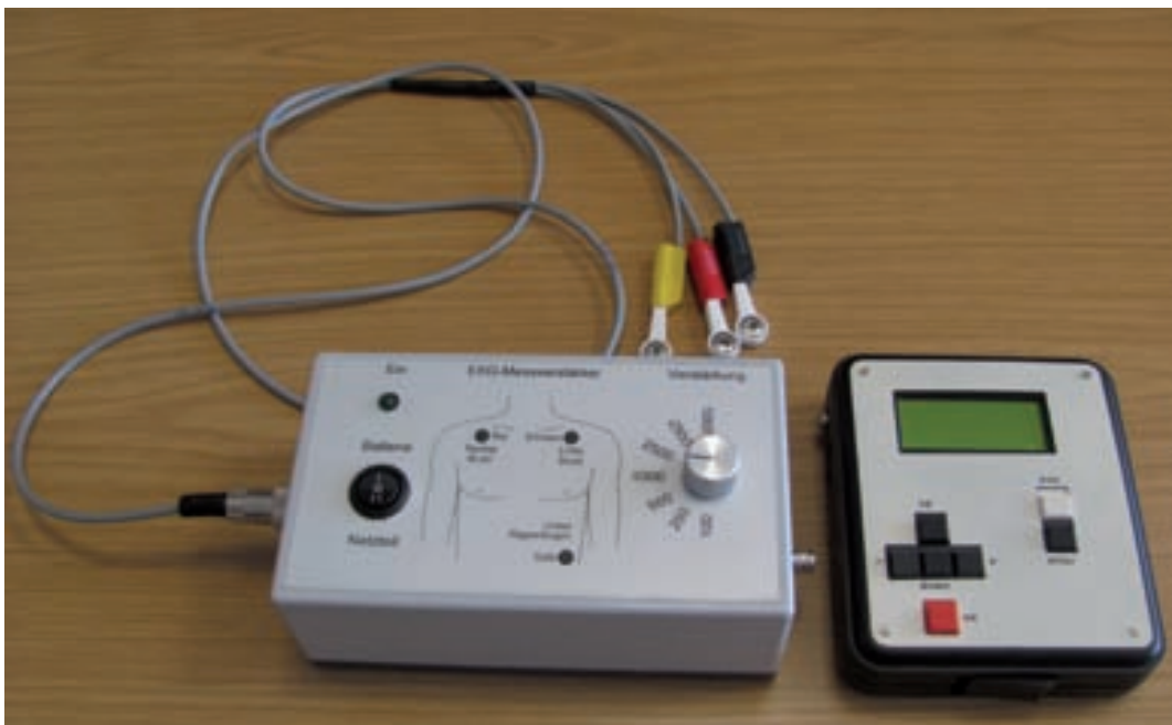
BILD 2: EKG-SIGNALMESSVERSTÄRKER (LINKS) UND PATIENTENADAPTIVER DIABETES-CONTROLLER (RECHTS)
