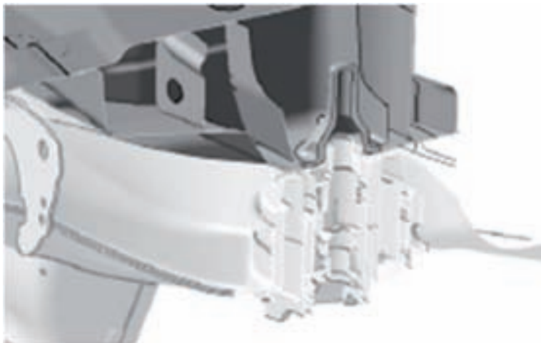
BILD 2: EINGESCHWEISSTE GEWINDETUBE IM TRÄGERTEIL EINES PKWS
