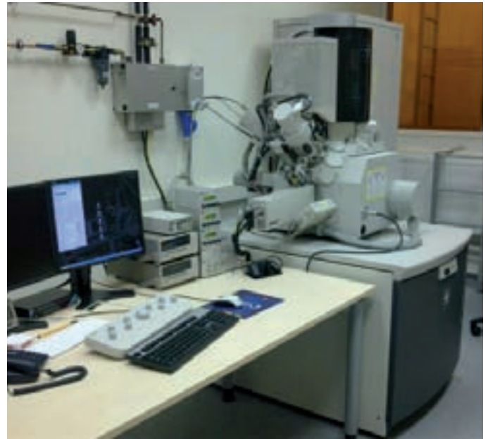
BILD 2: FOCUSED-ION-BEAM-SYSTEM ZUM HOCHGENAUEN SCHNEIDEN UND STRUKTURIEREN MIT FOKUSSIERTEM GA-IONENSTRAHL UND ZUR HOCHAUFLÖSENDEN RASTERELEKTRONENMIKROSKOPIE
