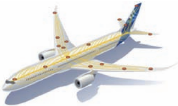
BILD 2: SCHEMADARSTELLUNG EINER FLUGZEUGSTRUKTUR MIT ÜBERWACHUNGSSENSOREN, QUELLE: EADS
