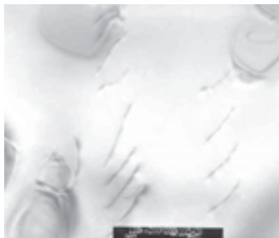
BILD 4: VORSTUFE ZUR SCHÄDIGUNGSENTWICKLUNG IM VHCF-BEREICH: AUFNAHME VEREINZELTER VERSETZUNGSLINIEN ANGEORDNET IN EINER NICKELBASIS-SUPERLEGIERUNG AM TRANSMISSIONSELEKTRONENMIKROSKOP.
