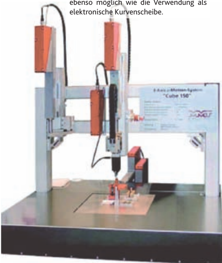
BILD 2: KOMBINATION VON 3 LINEARAKTOREN FÜR RÄUMLICHE POSITIONIERUNGS-AUFGABEN
