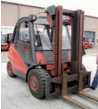
BILD 2: EINSATZ VON FLYERKETTEN IN GABELSTAPLER-HUBEINRICHTUNGEN
