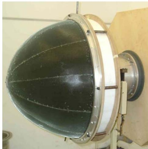
Bild 3: Turbulenzschirm (TCS): Abmessungen und Montage an der Standard-Einlaufdüse des Ventilatorprüfstandes (s. Bild 2)
