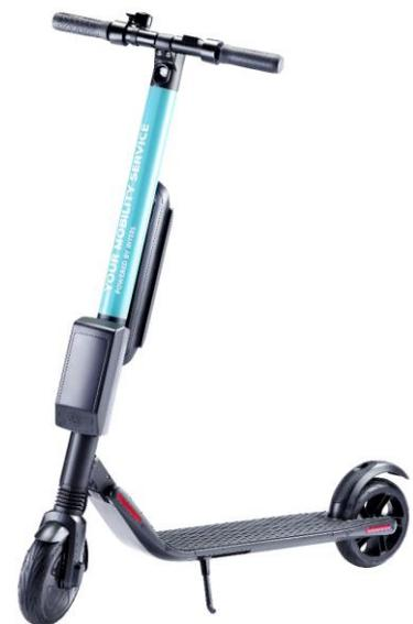
Abb. 1: E-Scooter mit Telematikeinheit am Lenkrohr
