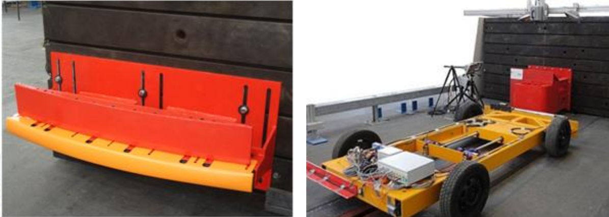
Abbildung 2: RCAR-Barriere (li.) und Schlittentest an 10°-AZT-Barriere (re.)
