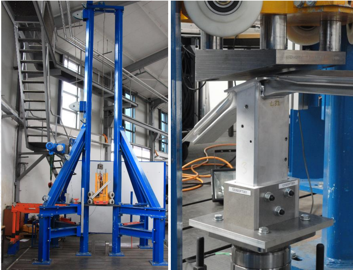
Abbildung 1: Fallturm (li.) und Beispielaufbau eines Komponenten-Crashtests (re.)
