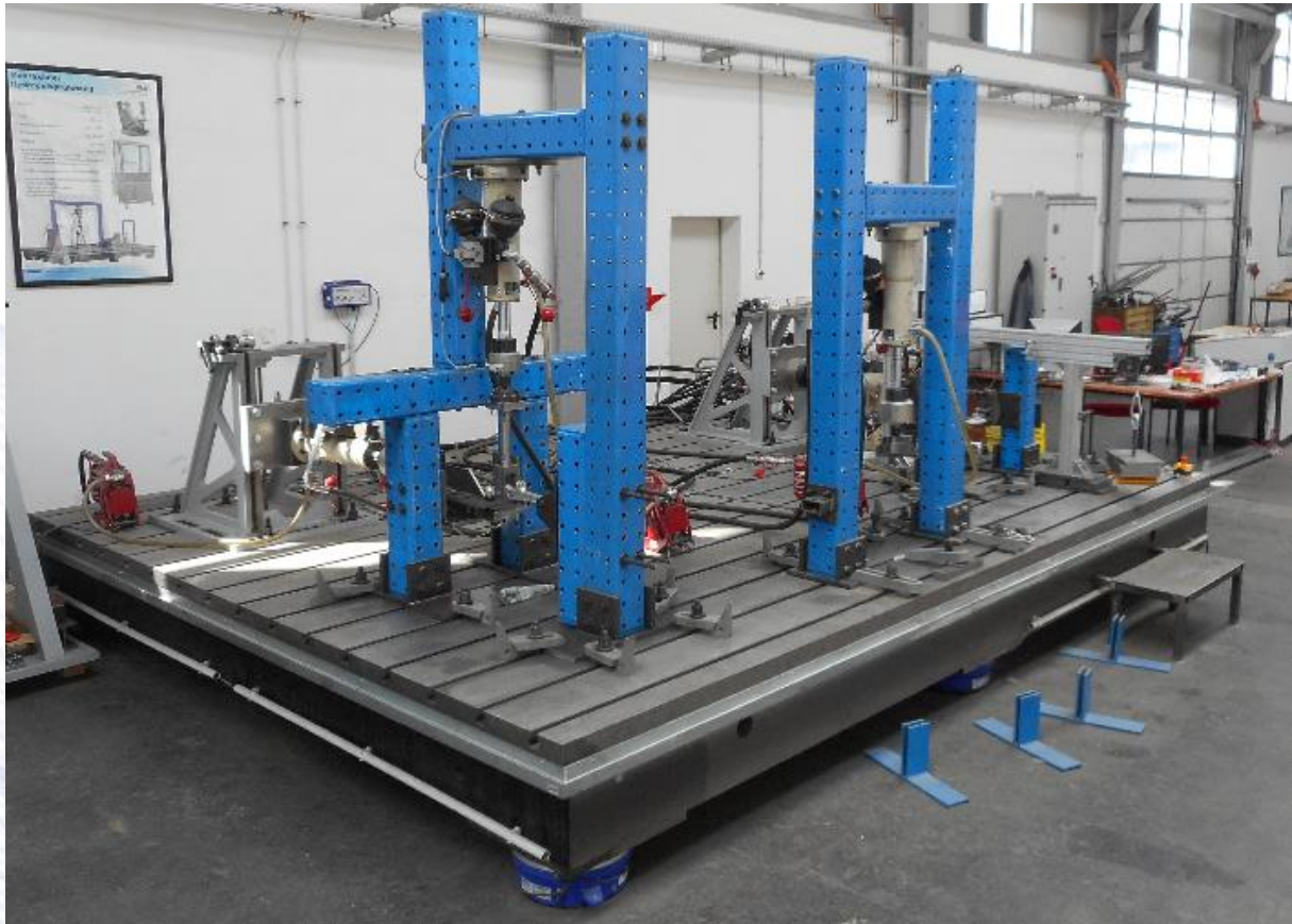
Abbildung 4: Flexibles Spannfeld für mehraxiale Bauteil-Prüfung
