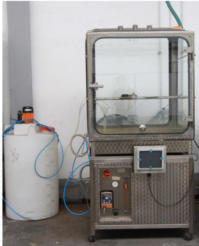
Abbildung 13: Korrosionskammer mit angeschlossenem Tank (Salzlösung)
