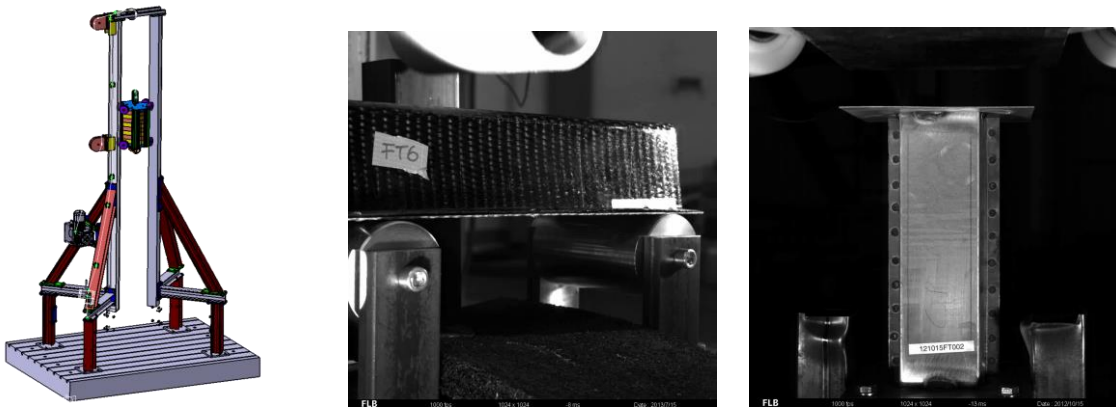
Abb. 1: Fallturm CAD-Modell (li.), 3-Punkt-Biegeversuch (Mitte), Axialer Crashversuch (re.)
