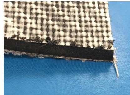
Abbildung 1: MSV aus PP-GF20 und GFK-Gewebe
