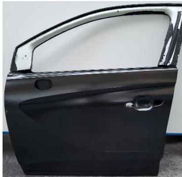
*Abbildung 1: Leichtbautür mit FVK-Rahmen*
