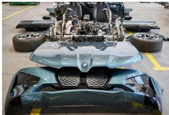
*Abbildung 2: Vollständig auseinandergebautes Fahrzeug für anschließendes Recycling*
