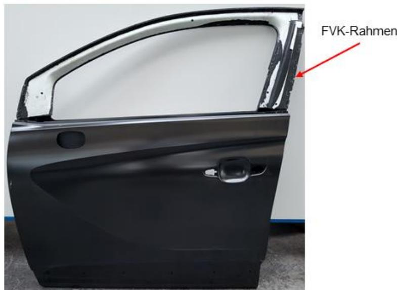
*Abbildung 1: Leichtbautür mit FVK-Rahmen*
