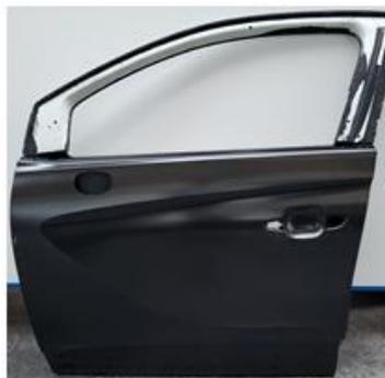
*Abbildung 2: Am FLB entwickelte Leichtbautür aus Aluminium, FVK und Stahl*
