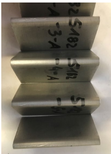
Abbildung 2: Proben nach der Prüfung mit Rissen in der Biegelinie
