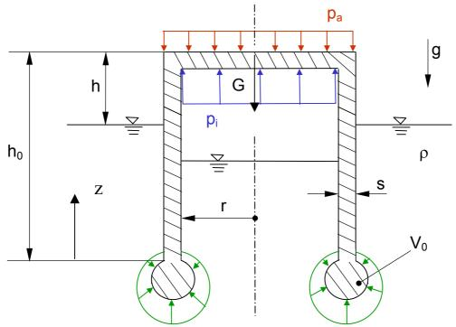
Berechnung der Auftriebskraft des Ringballastes mit Hilfe des Archimedischen Prinzips:
