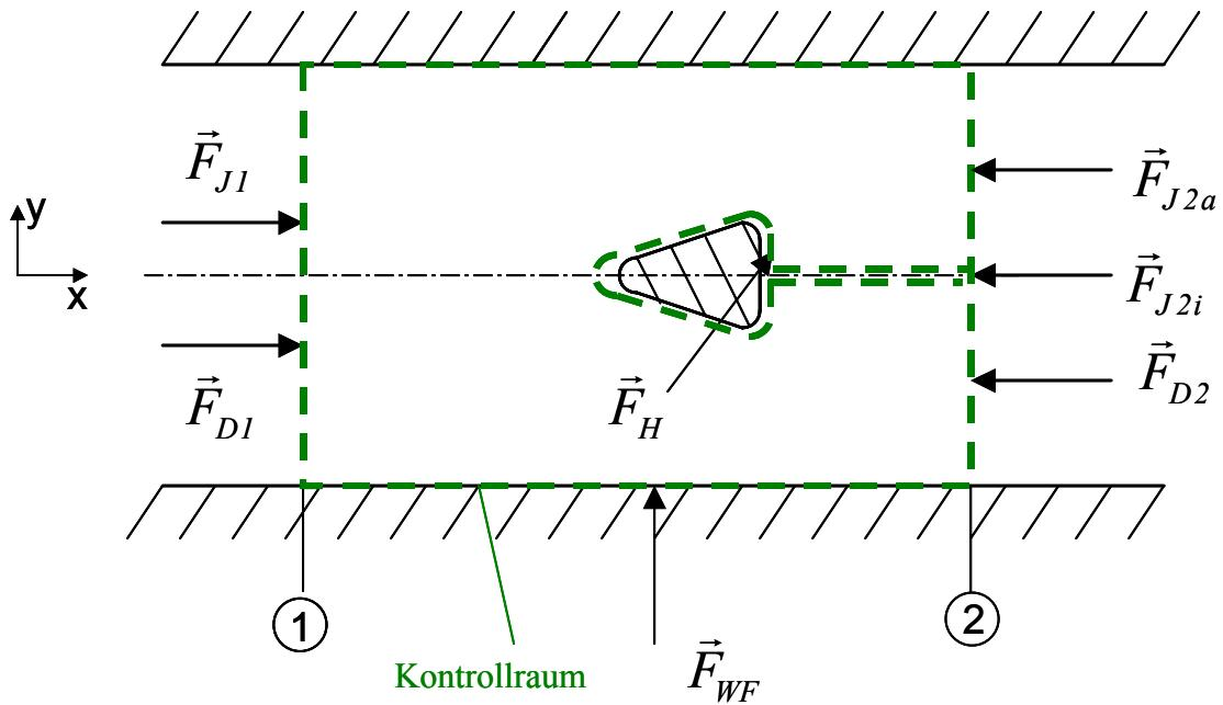
Wegen reibungsfreier Strömung im Außenbereich wirkt an der Kanalwand keine Reibkraft!
