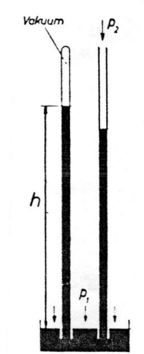
Abb. 7 Quecksilber-Baro-Vakuummeter nach Lambrecht
