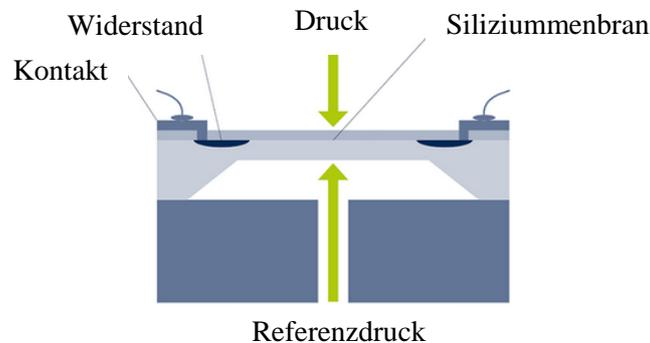
Abb. 9 Schematischer Aufbau eines piezoresistiven Drucksensors mit Siliziummembran
