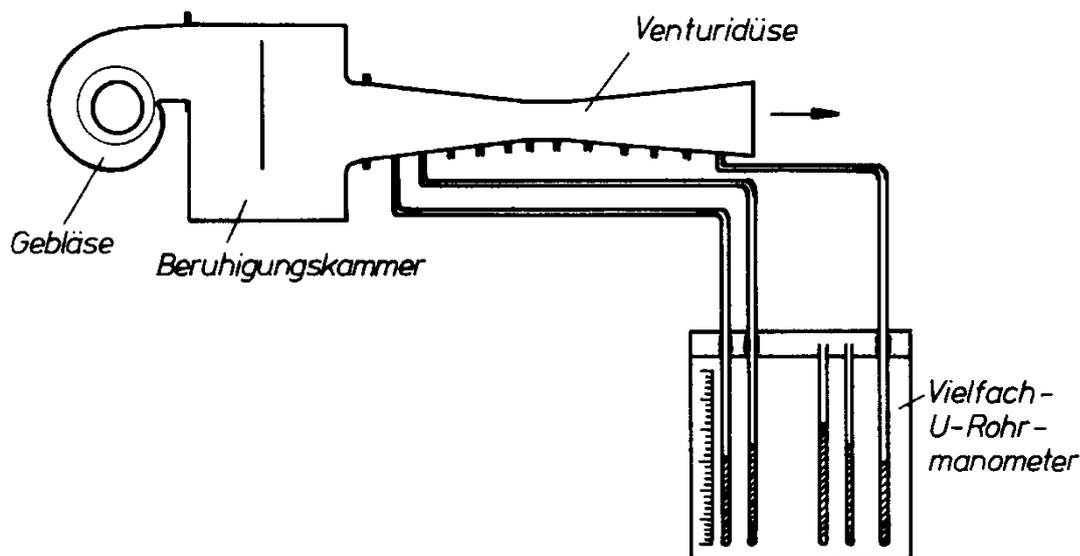
Abb. 13: Versuchsaufbau
