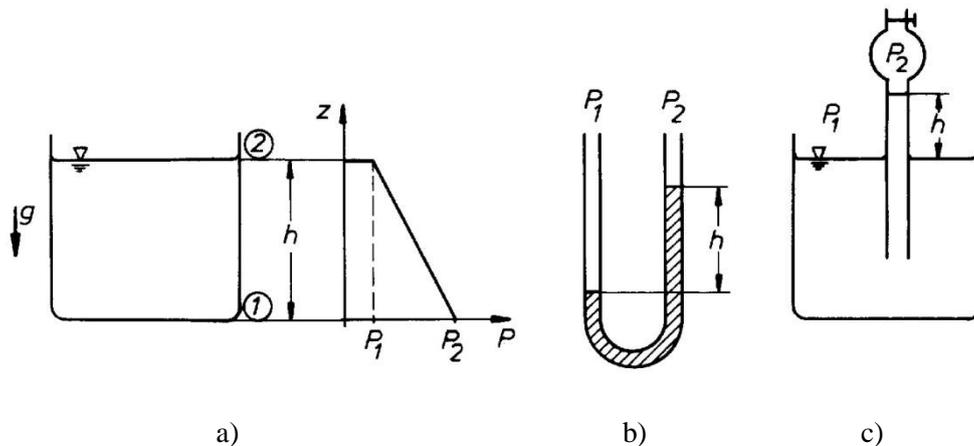
**Abb. 5:** a) Druckverlauf in einer ruhenden Flüssigkeit im Schwerfeld; b) U- Rohr- Manometer, c) Prinzip des Barometers
