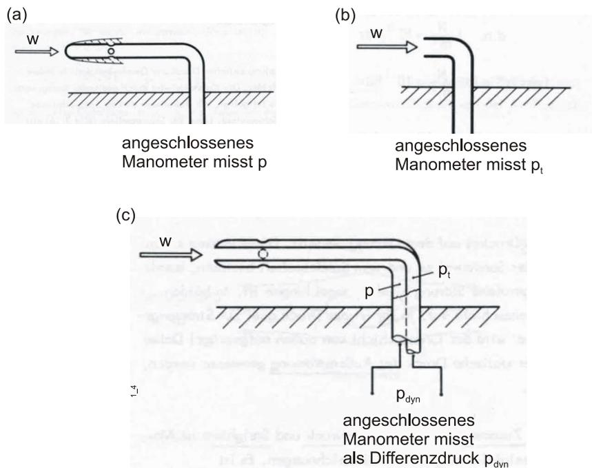
**Abb. 10:** a) Statische Sonde, b) Pitot-Rohr, c) Prandtl'sches Staurohr
