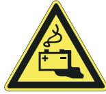
Gefahren durch Aufladen von Batterien
