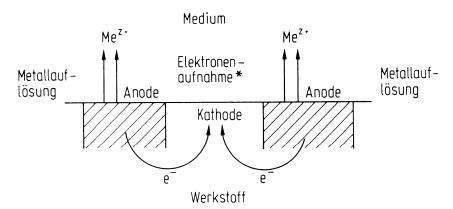
\*Säurekorrosion : 2H<sup>+</sup> + 2e<sup>-</sup> → H<sub>2</sub>
