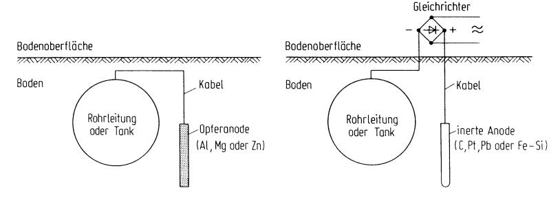
Statt der elektrischen Versorgung kann zur Polarisierung auch eine Opferanode aus einem unedleren Werkstoff (Al, Mg, Zn) verwendet werden.
