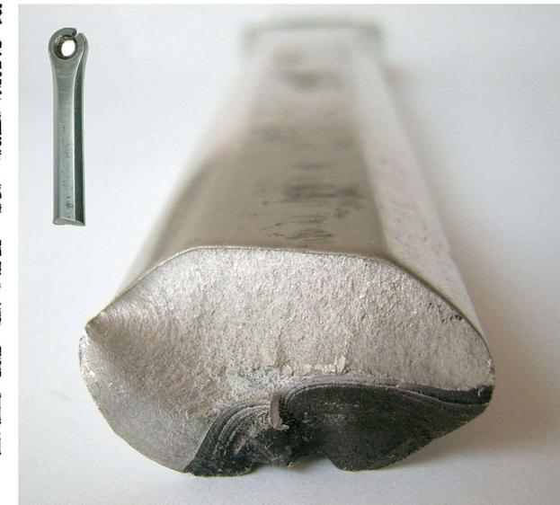
Schwingbruch eines Pedalarms
