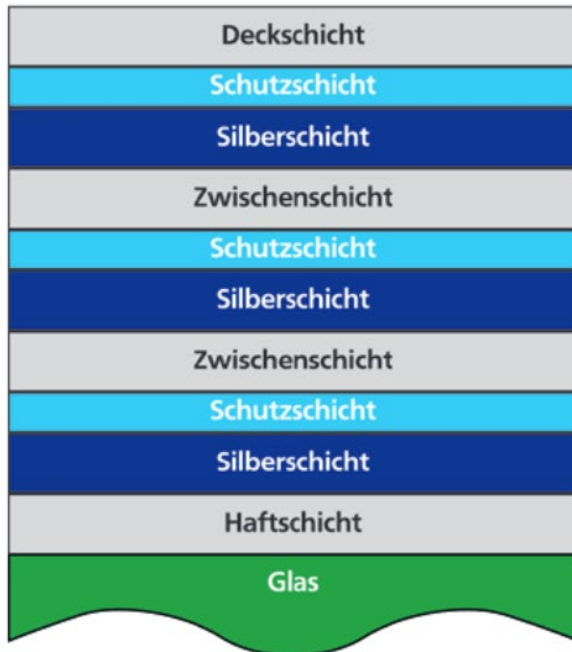
Schematische Darstellung einer 2-fach- bzw. 3-fach-Silber-Sonnenschutzbeschichtung
