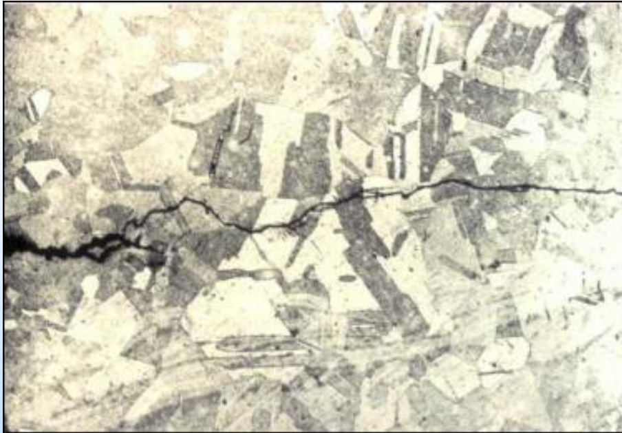
Transkristalliner Verlauf der Spannungsrissskorrosion
