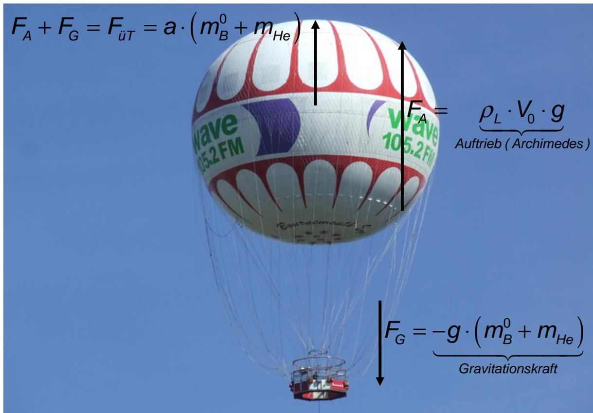
Tragkraftüberschuss des Ballons:  $F_{\text{üT}} = F_A + F_G$
