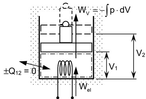
3.4 geg: Ideales Gas gemäß der Abbildung mit  $c_v = 718 \text{ J}/(\text{kg}\cdot\text{K})$ .
