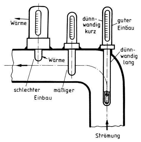
Einbau von Thermometerschutzhülsen.
