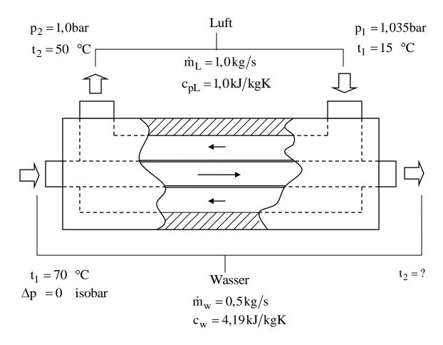
Wärmeaustausch zwischen Luft – und Wasserstrom durch Wärmeleitung und Wärmeübergang.
